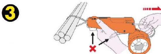
Aprlete la correlo tirando hacia atrs , de manera que se apriete el objeto. Advertencia NO presione las palancas durante el funcionamiento.
