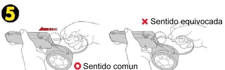
Inserte la correlo en la parte posterior de la pistola respetando el modo . Lado liso afuera.
