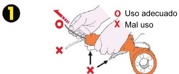
Inserte la correlo que sale de la caressa de la bobina en la parte trasera de la pistola . Los tanga emergen a travs de la oerradura , curvada hacia arriba. NO presione las palancas durante la operación.
