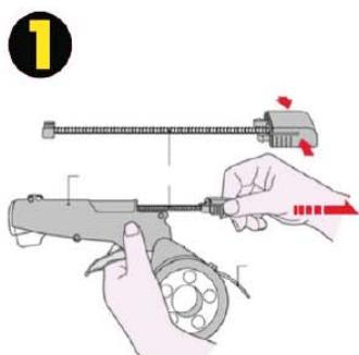
Para abrir el cargador oerraduras , eliminar empujador presionando en ambos lados.
